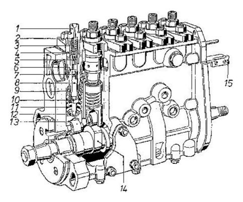
Fig. 3.11: Diesel injector pump (Bosch).
