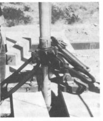
Figure 5.2. A pipe clevis.
