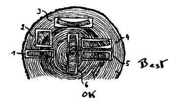
BRAUCHBAR SCHLIMM Luvseite BRAUCHBAR Verzug von etwas feuchtem Verzug von Holz beim Austrocknen: extrem trockenem Kernseite wölbt sich, also: Lee! Holz: Kernseite Luv! Blockverleimte Bohle:
